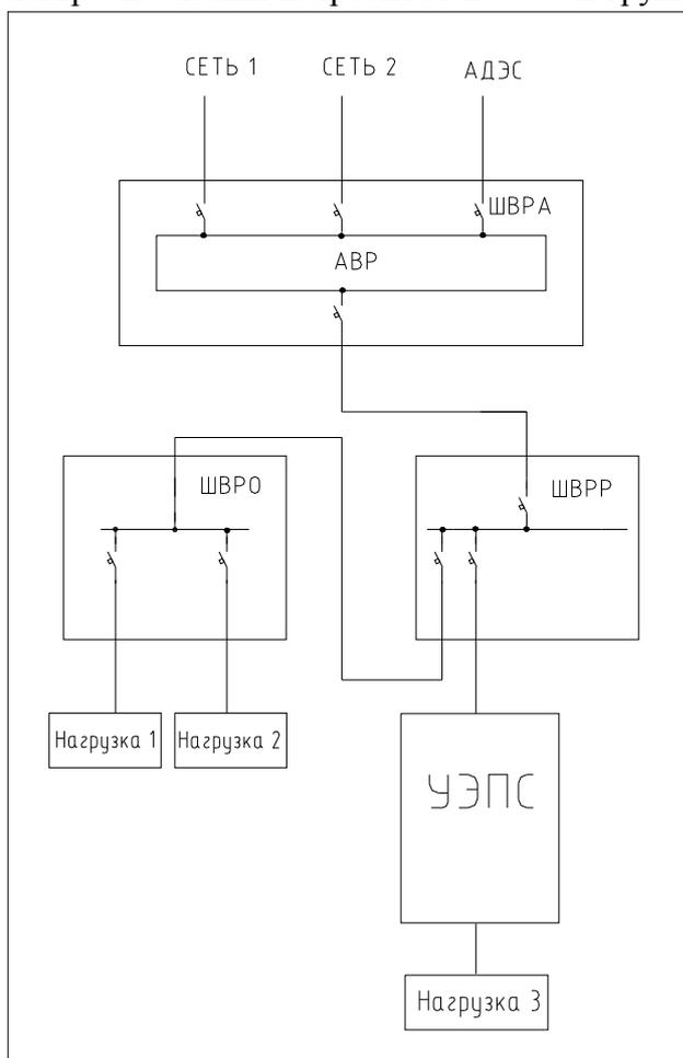
Рис.4 (а, б, в). Варианты схемы ШВРА с двумя вводами от сети
