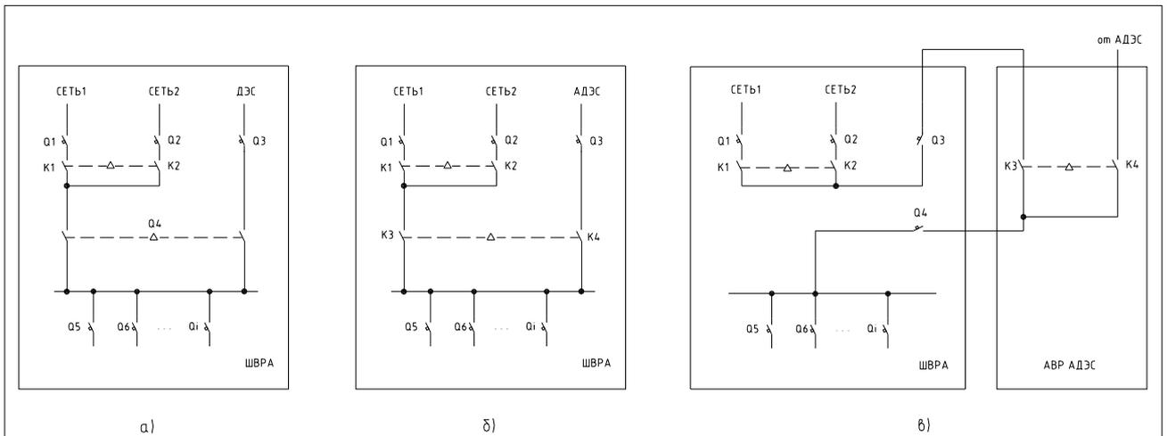
Рис.6. Схемы подключения шкафов ШВРР к различным системам переменного тока
