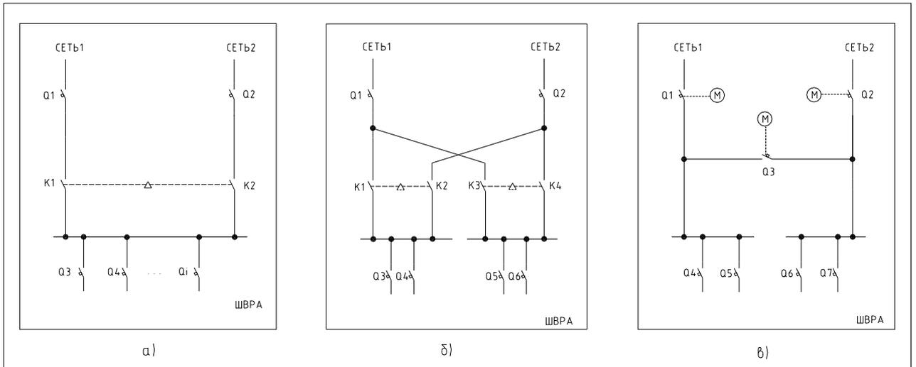
Рис.5 (а, б, в). Варианты схемы ШВРА 380/In-21П (С)
