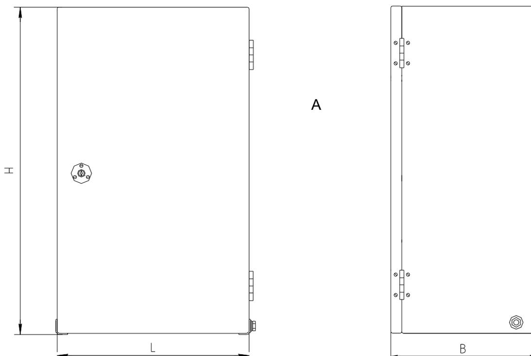
Рис.2. Габаритный чертеж шкафа ШВР в напольном исполнении(габаритные размеры в соответствии с табл.1)
