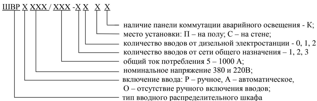
Шкафы выпускаются с ручным подключением вводов (ШВРР), с автоматическим переключением вводов (ШВРА) и без автоматического выключателя для включения вводов (ШВРО). Предусмотрена возможность подключения к ШВР одного и более питающих вводов от сети общего назначения, а также дизельной электростанции (ДЭС).
